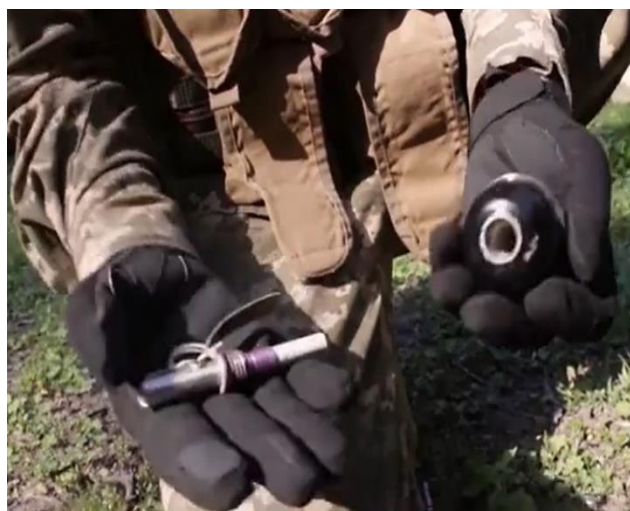
Рисунок 51 – Запал перед закручуванням в корпус гранати
