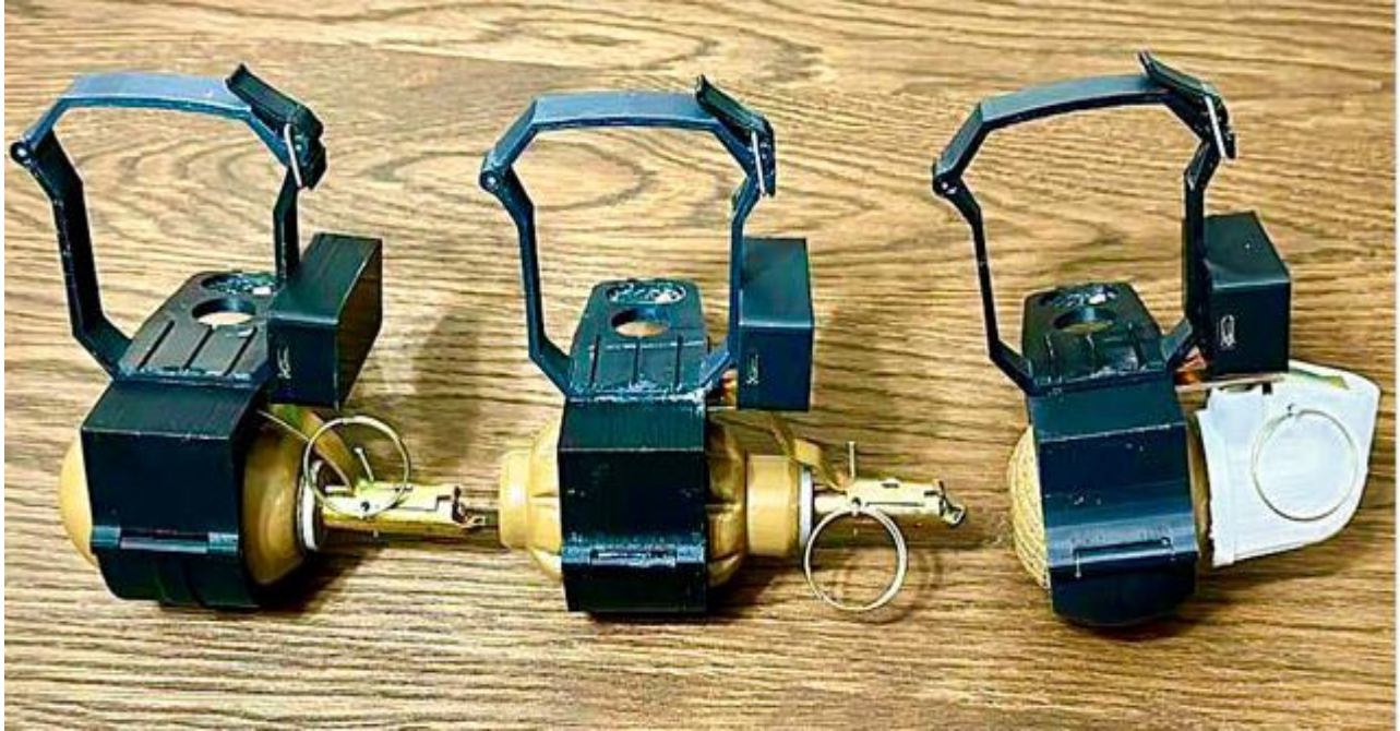
Рисунок 69 – Універсальне обладнання, яке дозволяє дистанційно здійснювати скидання ручних гранат РГД-5, Ф-1, РГО (РГН), підготовлено для встановлення на квадрокоптери
