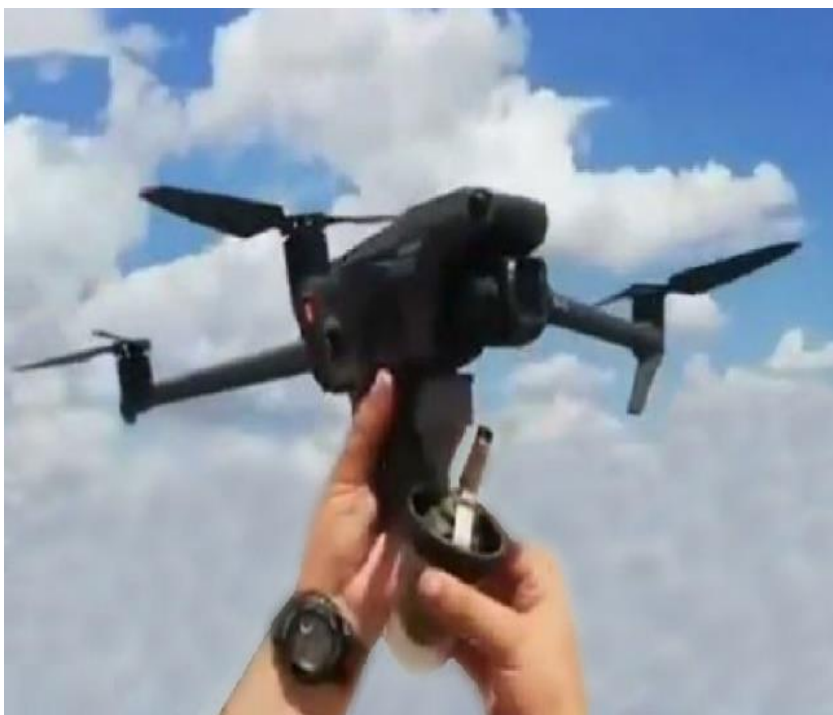
Рисунок 67 – Пластиковий стаканчик з гранатою всередині кріпиться до квадрокоптера
