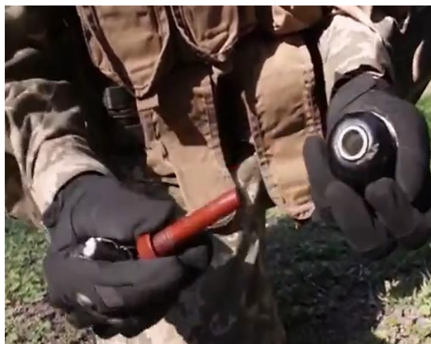
Рисунок 50 – Заглушка, яка відкручена з трубки корпусу гранати
