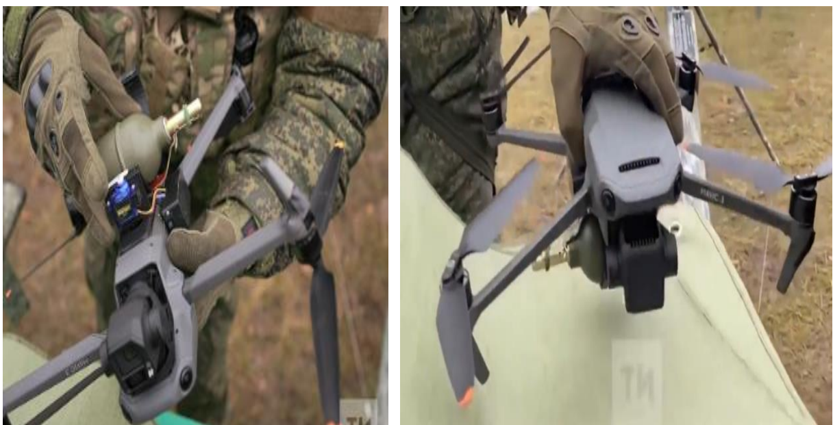
Рисунок 70 – Підготовка системи скидання гранати перед запуском FPV-дрона
