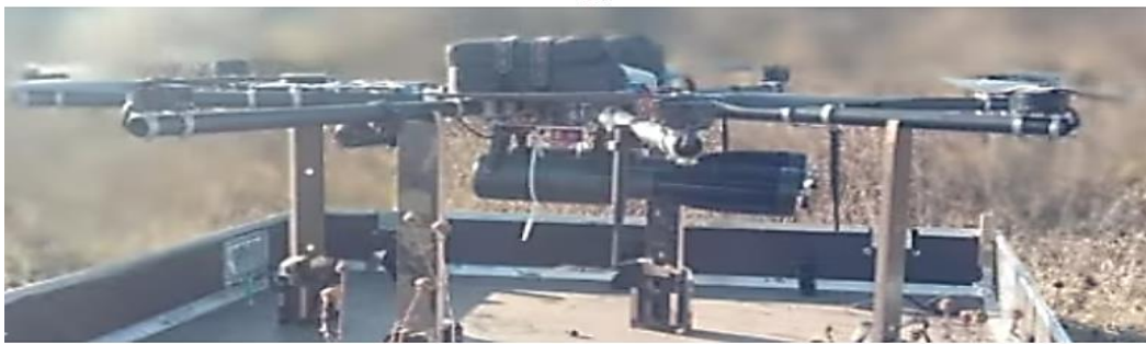
Рисунок 75 – Дрон-октокоптер R18: а – оператор закріплює гранату РКГ-1600; б – стандартне навантаження R18 - дві РКГ-1600
