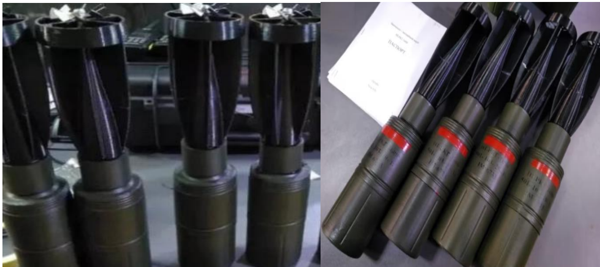
Рисунок 73 – Ручні кумулятивні гранати РКГ-1600 – модернізований варіант РКГ-3 (замість рукоятки до корпусу гранат кріпиться хвостове оперення)
