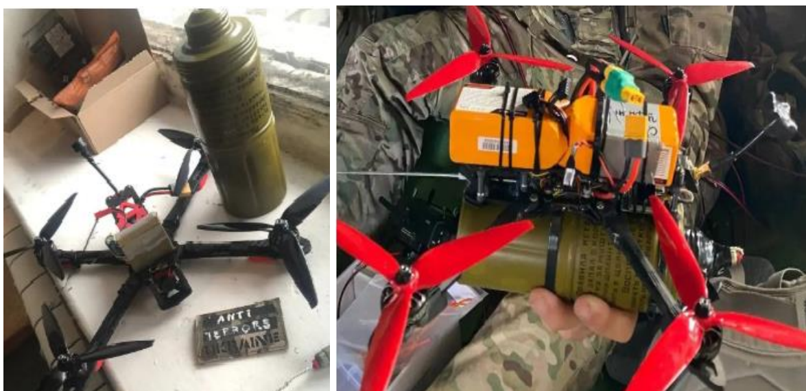
Рисунок 72 – Ручна кумулятивна граната РКГ-3 для скидання з БПЛА (рукоятка відсутня)
