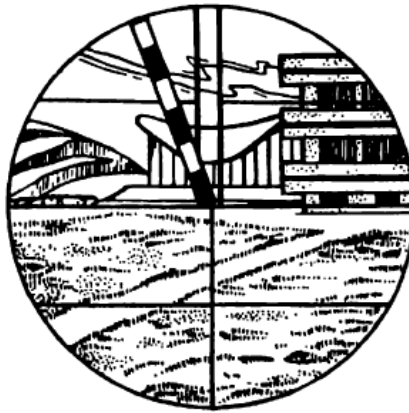
Рис. 7.12. Поле зору труби при наведенні на віху (зображення перевернуто)
