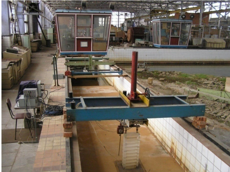
Рис.3.1 Гідрохвильовий лоток з досліджуваною моделлю
