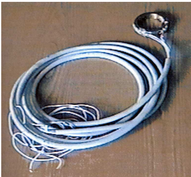
Рис.3.5. Датчики хвильового навантаження для реєстрації вертикальної (а) та горизонтальної (б) складових хвильового навантаження
