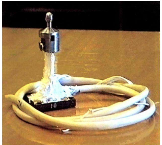
Рис.3.5. Датчики хвильового навантаження для реєстрації вертикальної (а) та горизонтальної (б) складових хвильового навантаження
