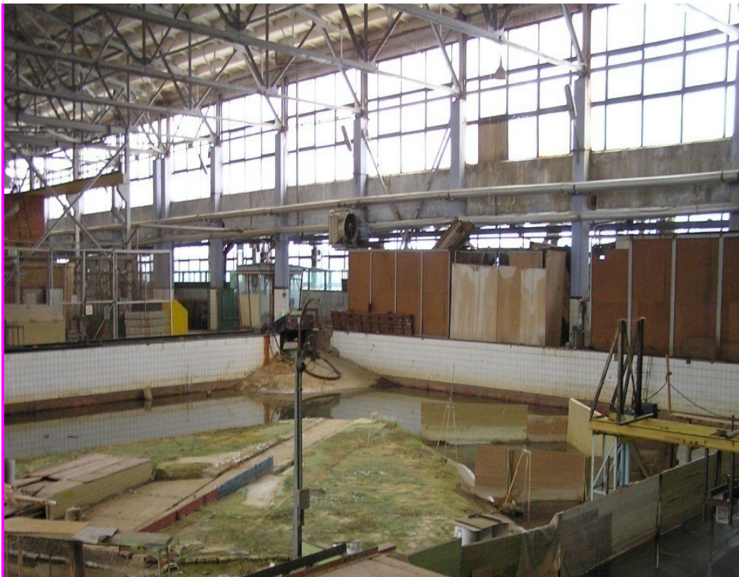
Рис.3.4 Мілководний басейн з моделлю підхідного каналу та пересувним хвилепродуктором
