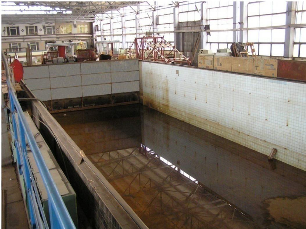
Рис.3.3 Глибоководний хвильовий басейн із стаціонарним хвилепродуктором
