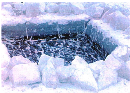
Рис. 3.15. Формування середньої частини торосу із заданою пористістю
