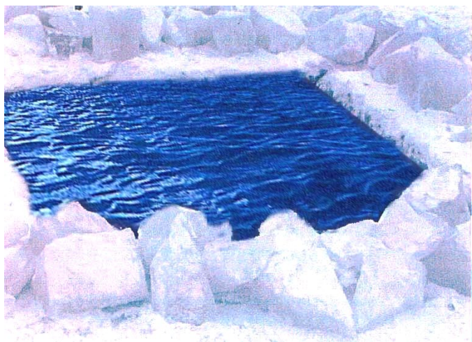
Рис.3.13. Майна для формування середньої частини торосу з нульовою пористістю
