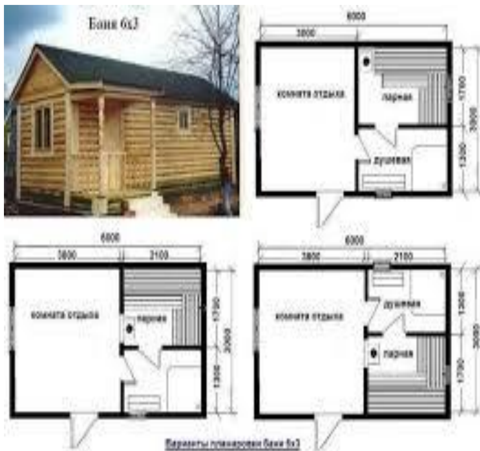
Рисунок 10.1 – Приміщення у лазні
