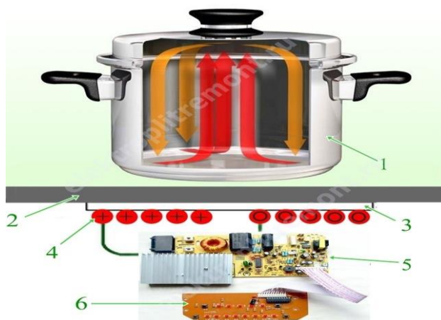
Рисунок 6.3 – Електроконтактне нагрівання: 1 – посуд; 2 – настил; 3–6 – електричний пристрій
