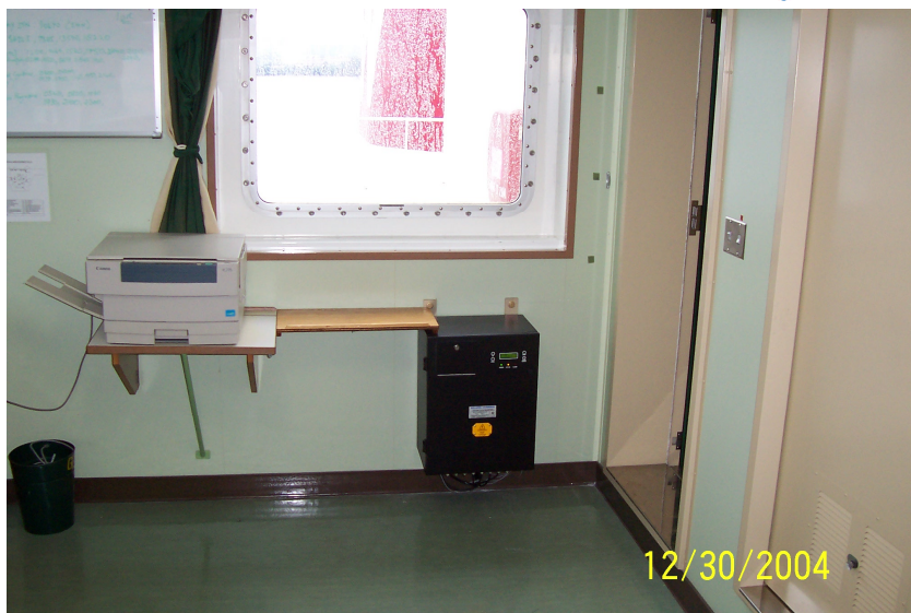
Рис.1.34 Зовнішній вигляд DCU реєстраторів даних рейсу різних виробників (а) та приклад розташування блока DCU на мості (б)
