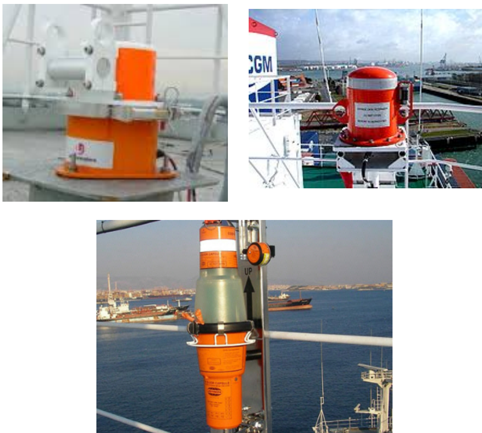
Рис. 1.38 Встановлення захисної капсули стаціонарного типу на судні
