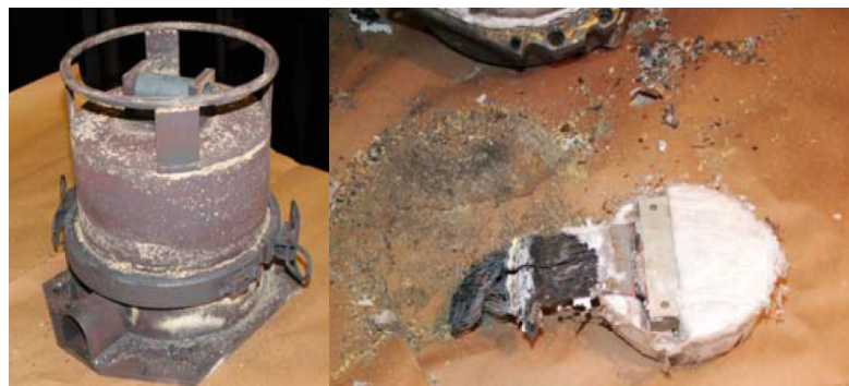
Рис.1.35 Вигляд захищеного накопичувача інформації та модуля FLASH-пам'яті цього пристрою після низькотемпературної (а) та високотемпературної пожежі (б). Модуль зберіг свою працездатність
