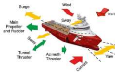
Рис. 5.10 Зовнішні сили, які впливають на судно, реакція судна на ці впливи і суднові пристрої для утримання позиції.
