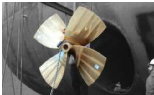
Рис. 5.5. Монтаж ТПУ на споруджуваному судні.
