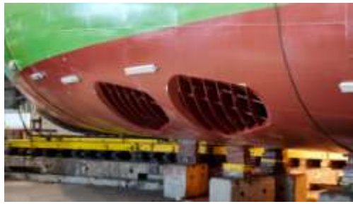
Рис. 5.9. ТПУ інноваційної конструкції в корпусі судна
