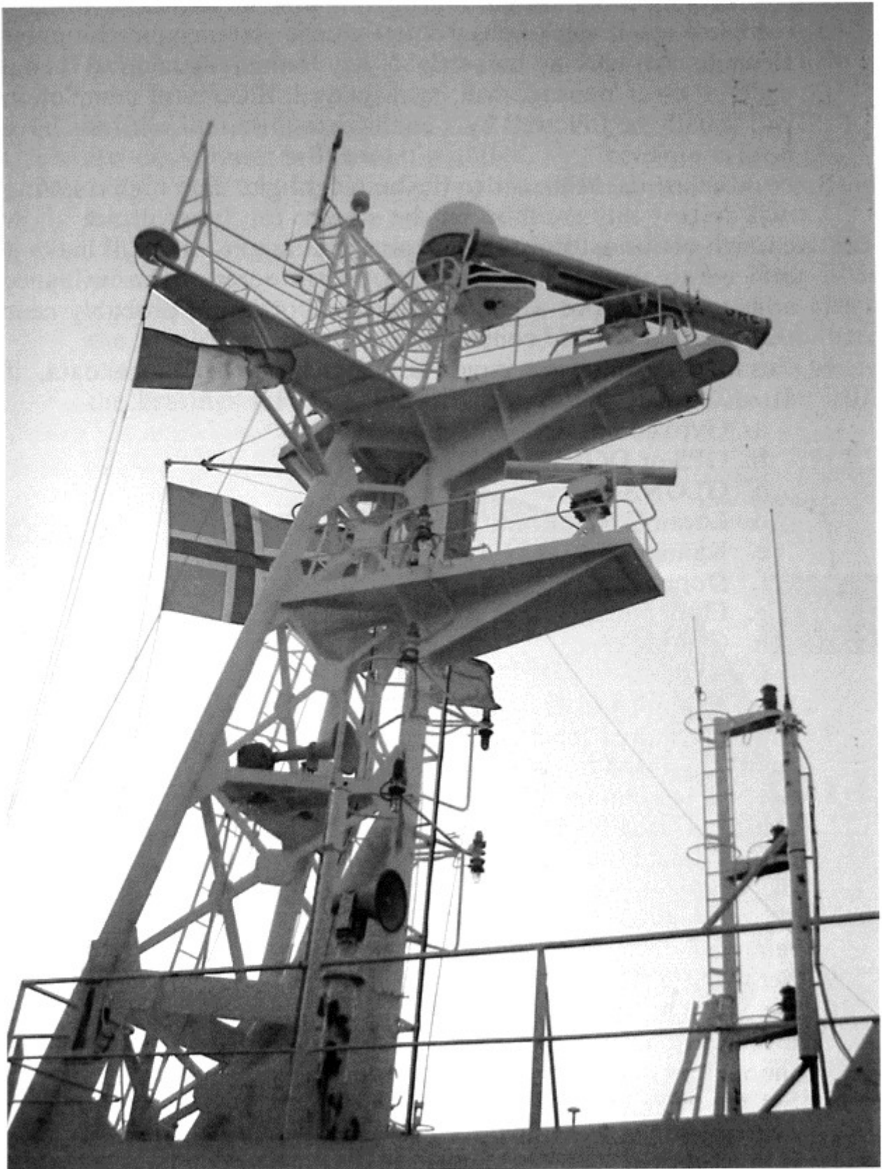
Рисунок 2.36 – Розміщення антени радіолокатора на щоглі судна
