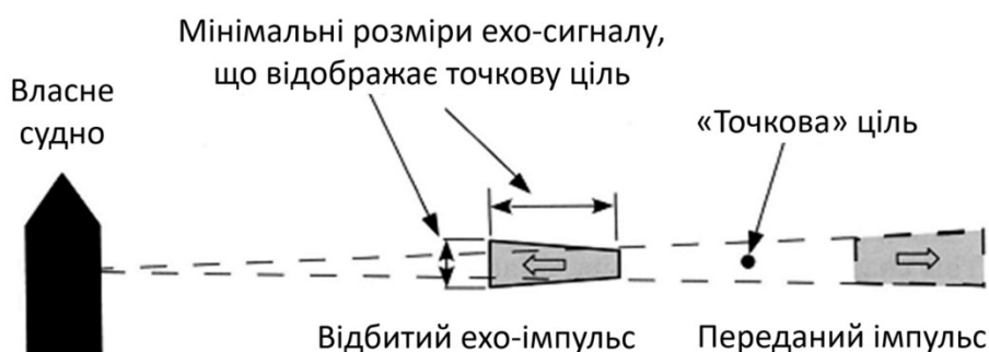
Рисунок 3.30 – Вплив тривалості імпульсу на формування відмітки цілі
