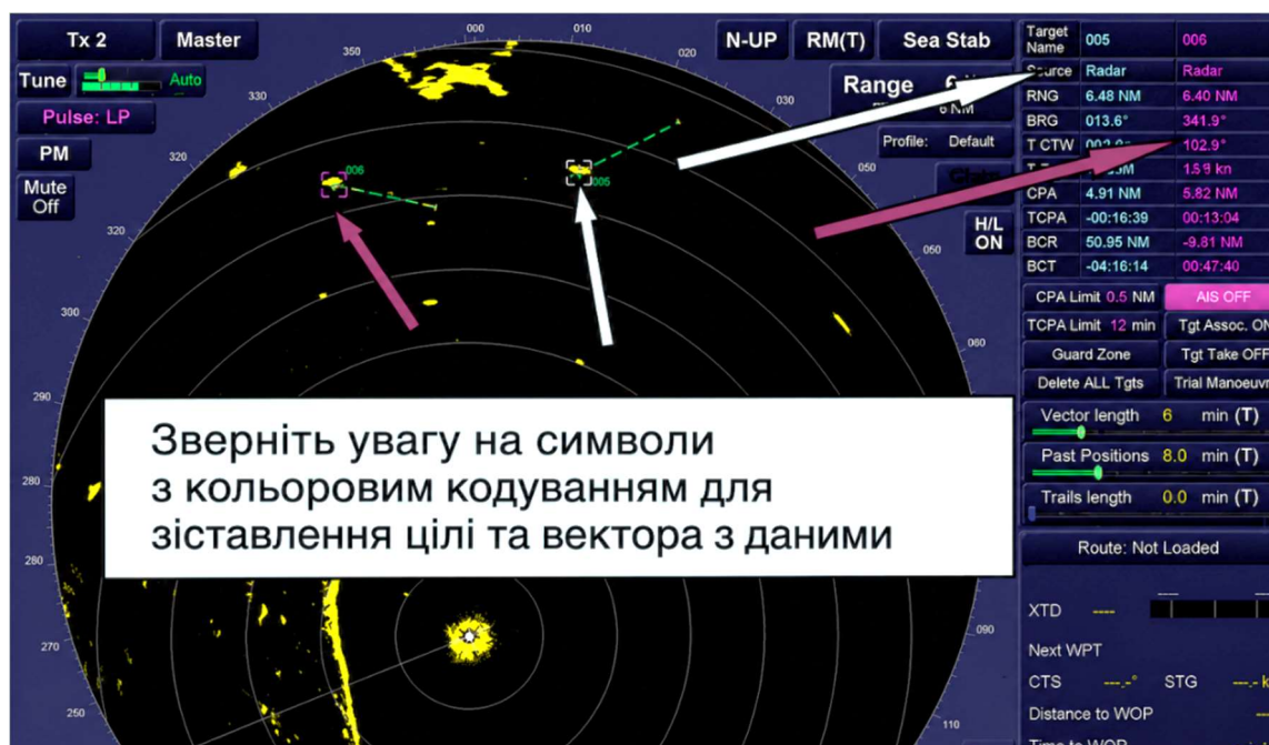
Рисунок 3.26 – Відображення векторів і параметрів цілей на екрані РЛС
