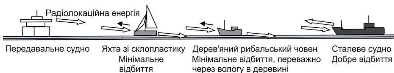
Рисунок 1.34 – Вплив матеріалу судна на характер радіолокаційного відбиття
