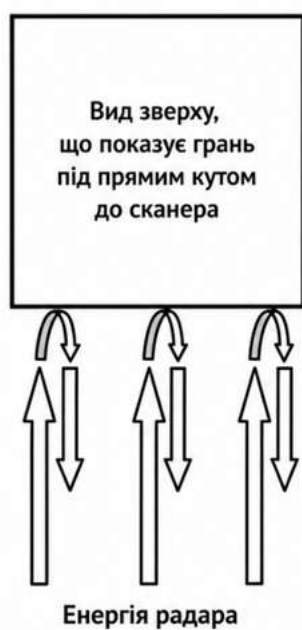
Рисунок 1.38 – Вплив орієнтації площини на інтенсивність відбиття
